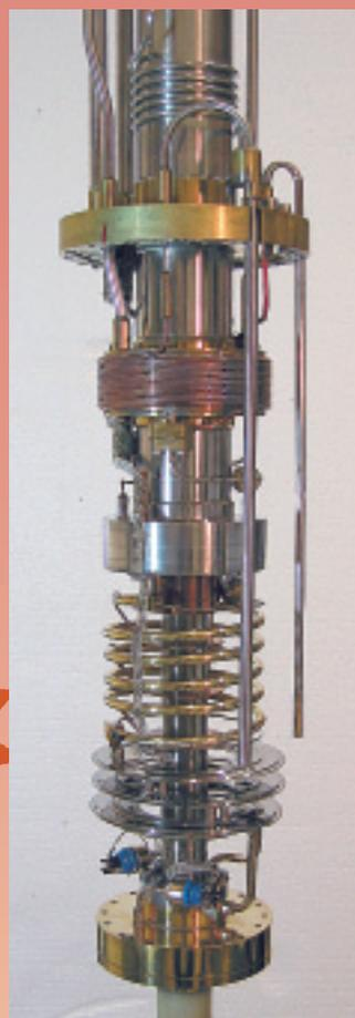
ヘリウム液化機（左上）、極低温超音波計測システムによる実験の様子（左下）、希釈冷凍機の心臓部（右）
