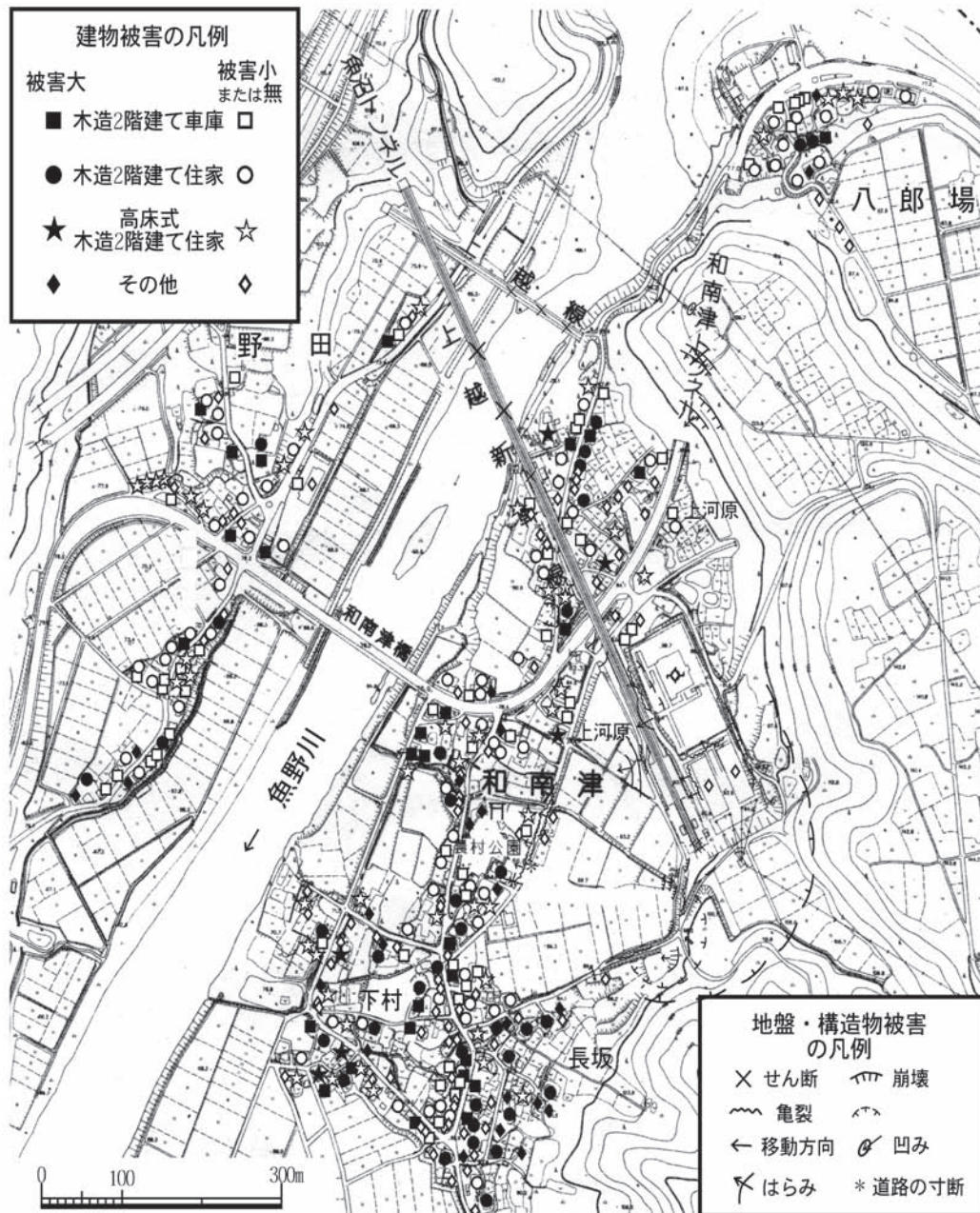
図2 川口町和南津地域の建物被害分布・地形図は川口町発行 1/10000 地形図を使用
