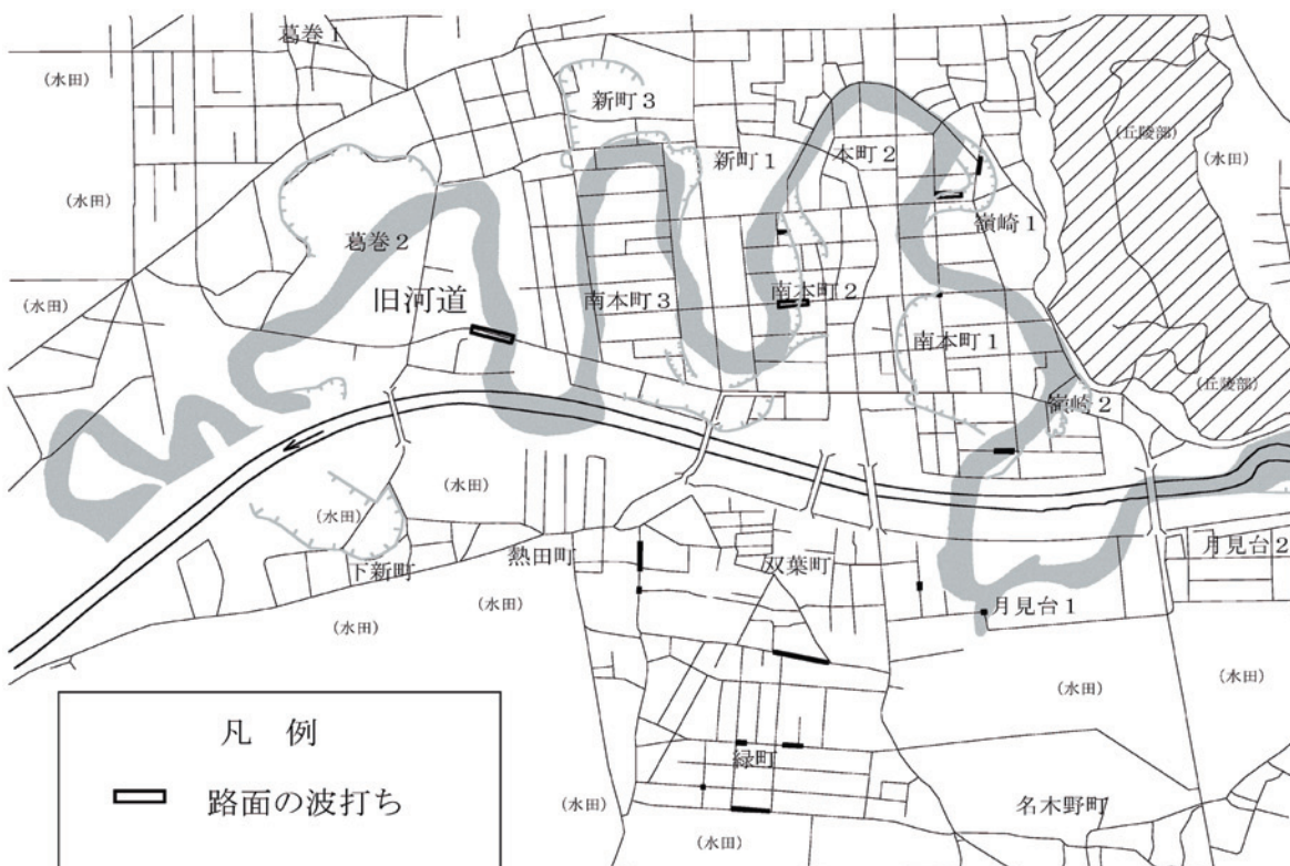
第 15 図. 路面の波打ちの発生箇所
