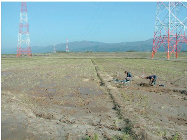
写真2 高梨の砂利採取した水田の陥没状況
