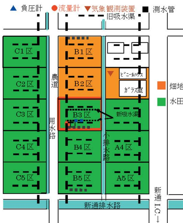
図 12 FC 新通の集水渠と新・旧吸水渠
