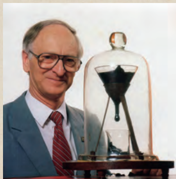
図1：クイーンズランド大学におけるピッチドロップ実験の様子。後ろに見えるのが故パーネル教授から実験を引き継いだ故メインストーン教授。残念ながらピッチ落下の瞬間を見ることなく2013年8月この世を去った。画像転載：日本語版ウィキペディア「ピッチドロップ実験」[ http://ja.wikipedia.org/wiki/ピッチドロップ実験 ] ライセンス：CC BY-SA 3.0
