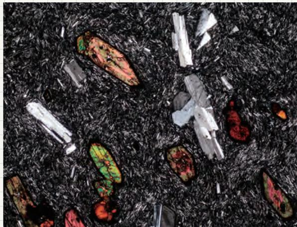
富山県に産する火山岩（安山岩）の偏光顕微鏡写真。横幅約6mm。
