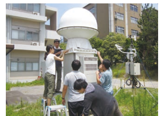
新潟上空の降水粒子の動きを観測する気象ドップラーレーダー
