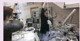
希釈冷凍機への液体ヘリウムの充填作業
